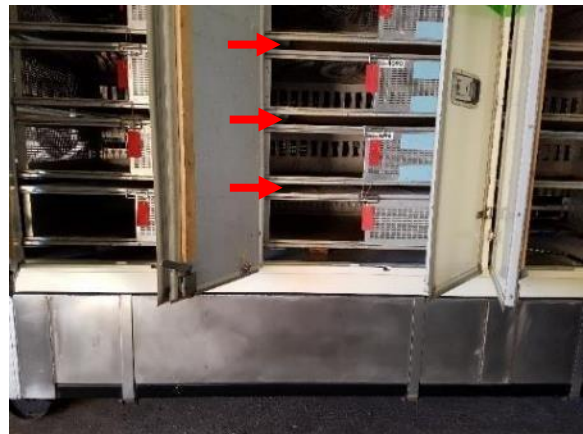
Ruimte tussen de manden (ca. 4 cm) zodat lucht ook door de geperforeerde bovenplaat van de mand deze kan verlaten
