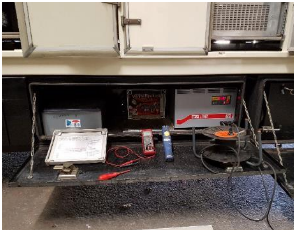
Accu van de wagen voor de voeding van de sensoren
