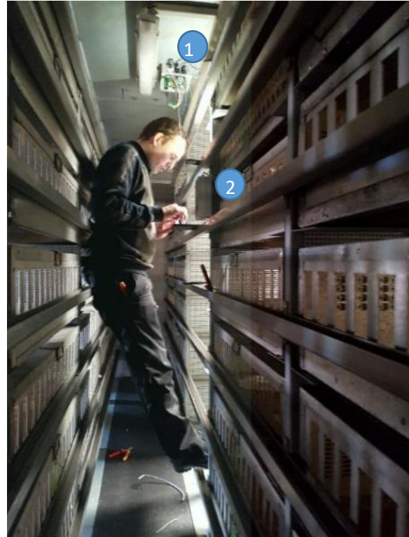
1: Locatie Euroscan MX1 voorin de wagen 2: Locatie CO 2 sensor voorin de wagen van binnenuit gezien
